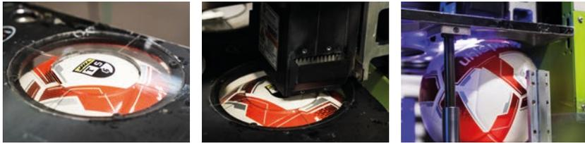
Das Logo wird mittels industriellem UV-Tintenstrahldrucker direkt auf die Balloberfläche gedruckt.
